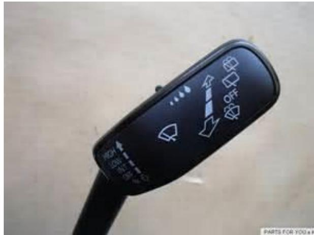
Um den Scheibenwischer einzuschalten, wird der Hebel hinaufgedrückt:
